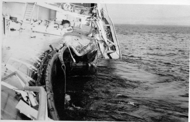
ENDAME CRUDE LAAG OP ZEE OPPERVLAK EN GASONTWIKKELING. SLIP 1 WAS LOSGE- RUKT EN GEHRAAKT.
