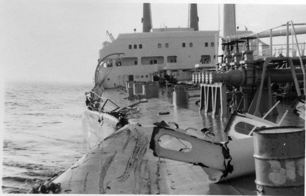
NOG STEEDS SLAGZY. OP DE POMPKAMER STAAT DE CREW TE KYKEN ALLEN IN BESTE PAK MET RADIO'S ETC, NOG STEEDS KLAAR OM \frac{1}{3} TE GAAN. VERMOEDELYK RAAKTE DE M. ONS MET HAAR SIDRES. A/D LIGT EEN ZWARE SLUITING. TUSSEN DE KREUKELS VONDEN WE NOG 3 SLUITINGEN EN VERFBLIKKEN.
